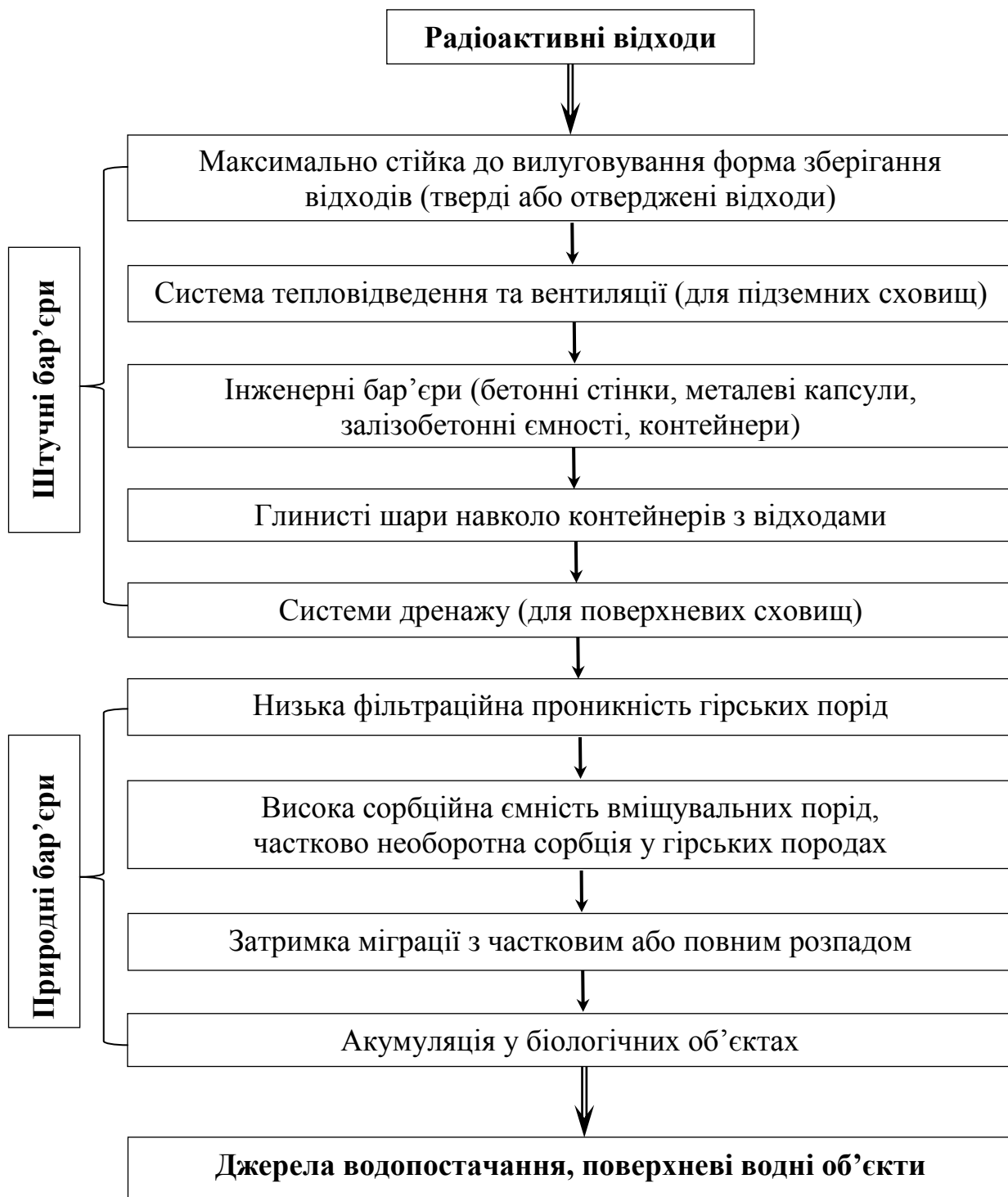
Рис. 8.3. Принципова схема мультибар'єрної концепції ізоляції РАВ у геологічному середовищі
