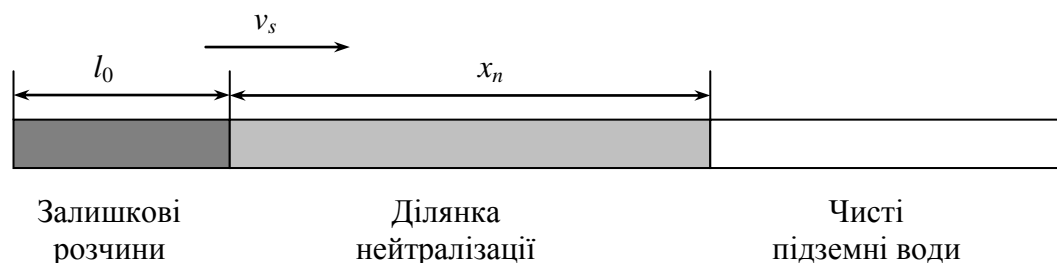
Рис. 7.6. Схема нейтралізації залишкових розчинів у фільтраційному потоці
