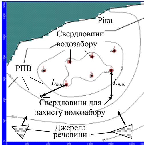
Рис. 5.3. Схема фільтрації та міграції в районі водозабору при його захисті
