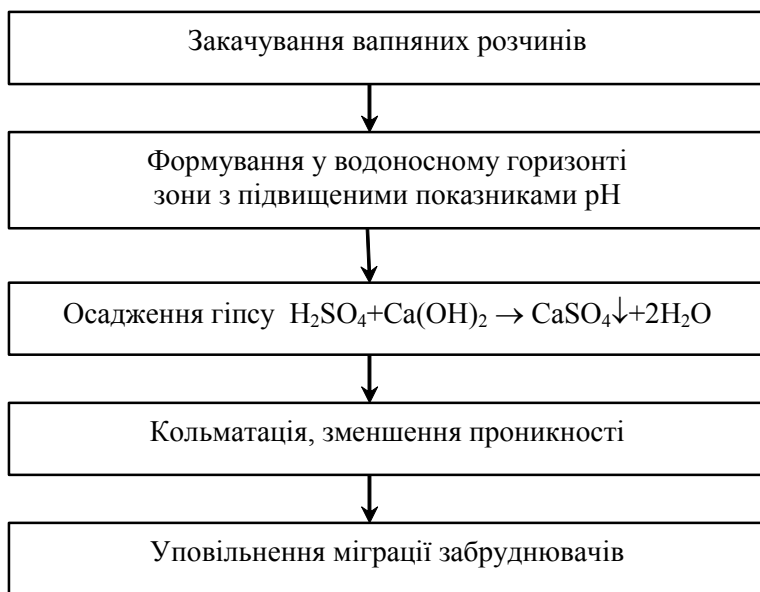
Рис. 4.5. Етапи фізико-хімічної нейтралізації кислотного забруднення у підземних водах
